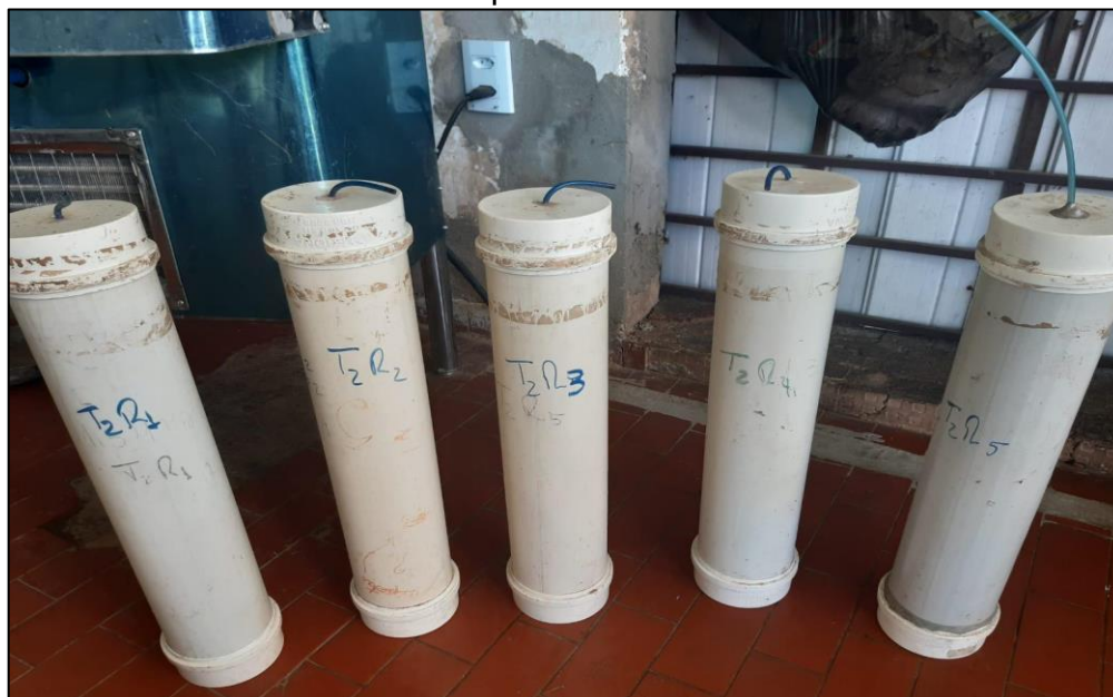
Figura 02 – Silos experimentais com vedação do tipo “taps” e provido de válvula do tipo Bunsen
