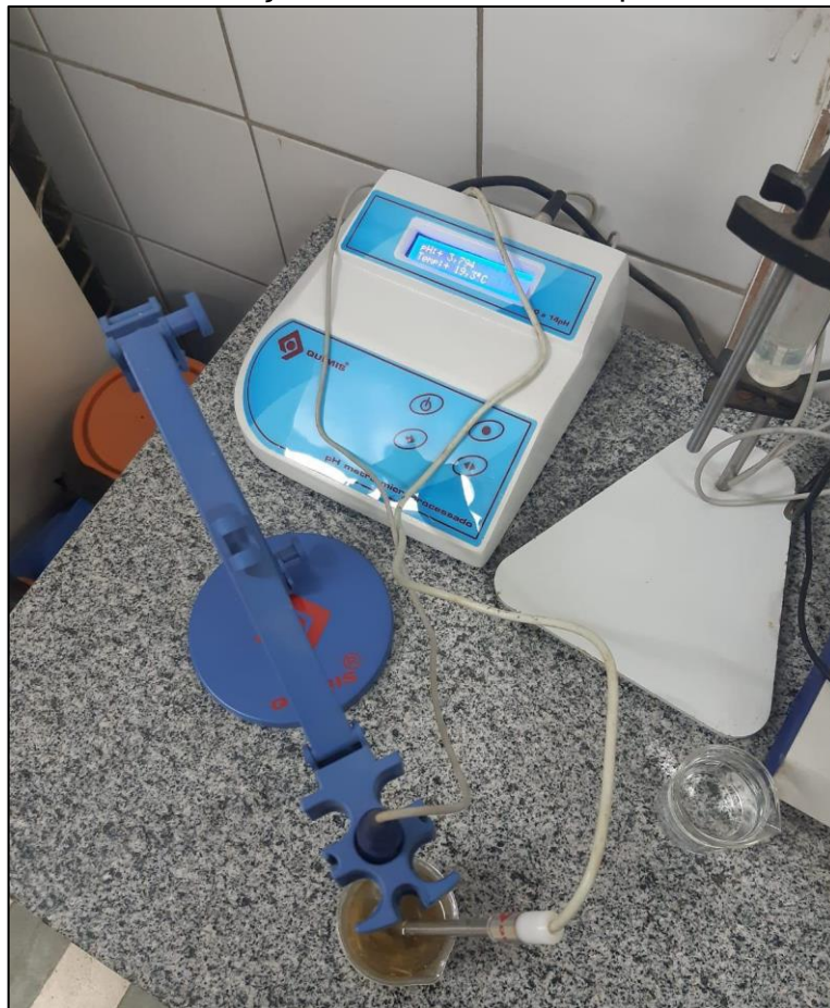
Figura 03 – Determinação do valor de Ph em potenciômetro digital
