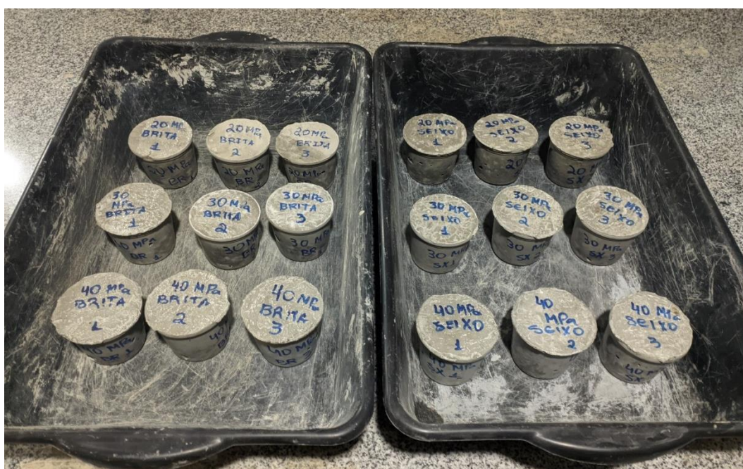
Figura 15 – CP's moldados e identificados em processo de cura inicial durante 24 horas.
