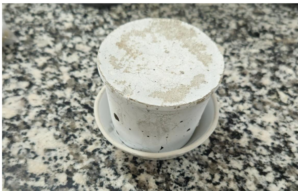
Figura 18 – Corpo de prova submetido ao processo de calcinação em forno mufla.
