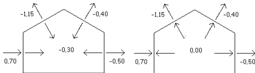
Figura 16 - Sobreposição dos coeficientes de forma e de pressão para vento transversal ( W90^\circ ).
