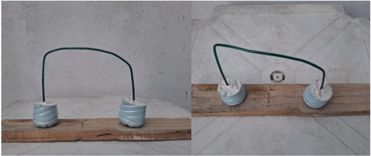
Figura 86: Arco Catenário Deformado
