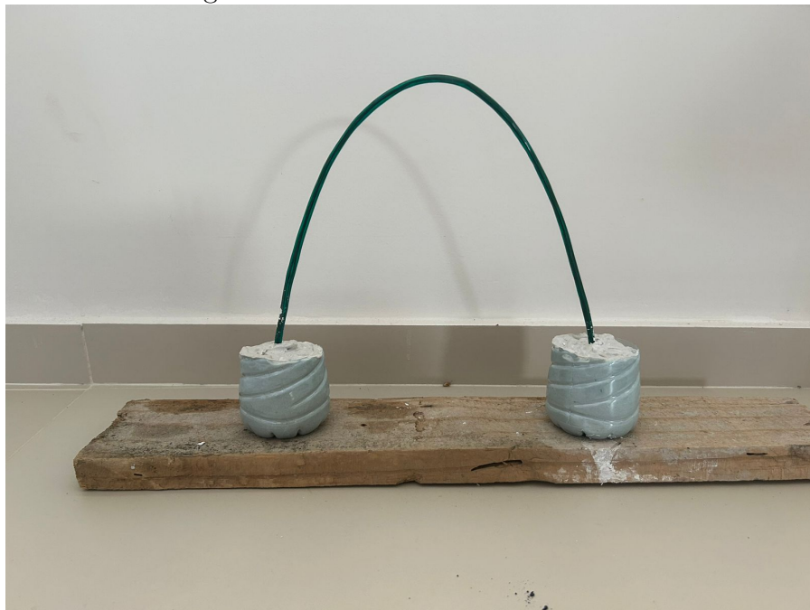
Figura 79: Arco catenário construído
