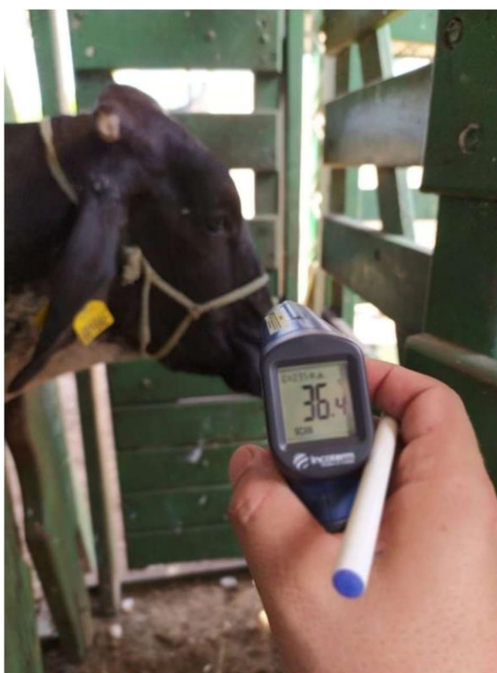
Imagem 6 - Coleta de temperaturas superficiais utilizando termômetro infravermelho
