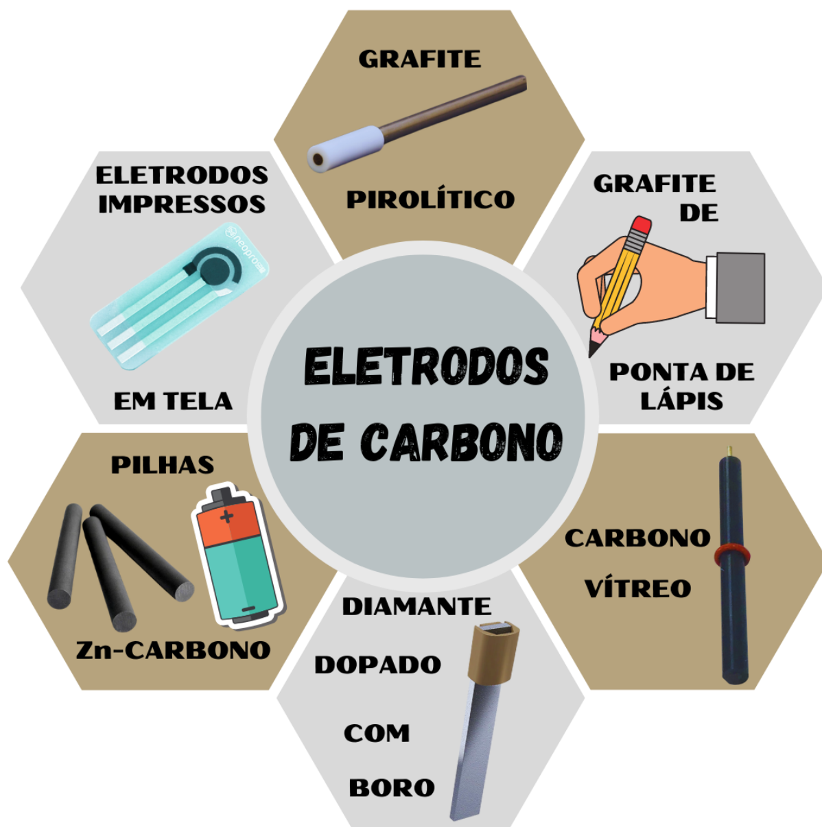
Figura 2.6. Tipos de eletrodos de carbono mais reportados na área eletroquímica. Fonte: De autoria própria.
