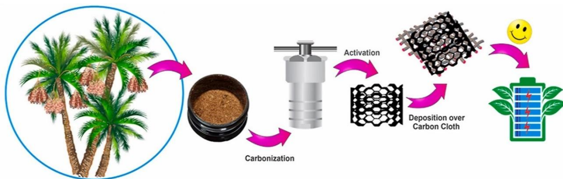
Figura 2.5. Esquema representativo para a metodologia de obtenção do carvão ativado oriundo das sementes de palmas.
