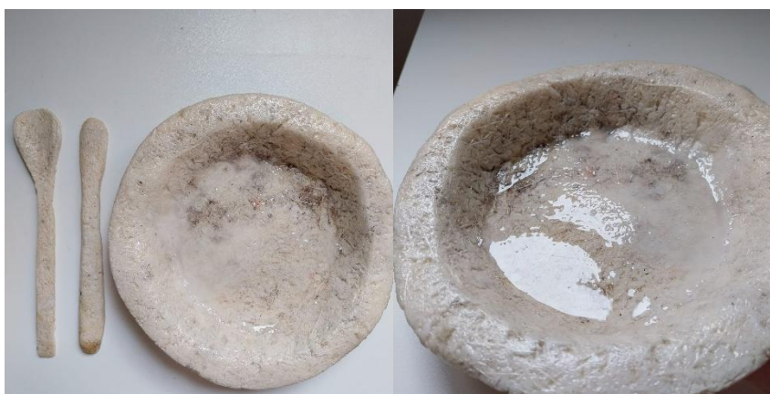
Figura 8 – Acabamento superficial da resina de silicone com álcool 70%. (Autoria própria, 2025).
