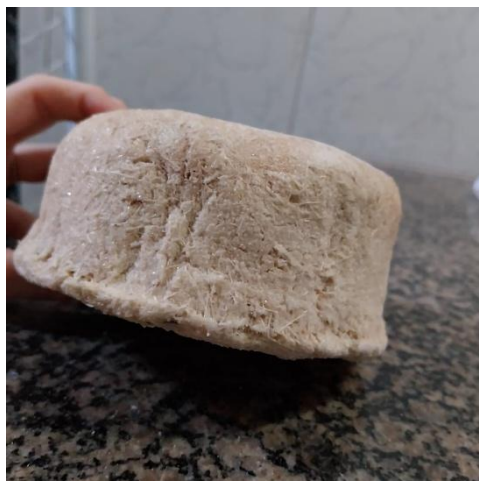
Figura 5 – Recipiente com espessura de 10 mm. (Autoria própria, 2025).
