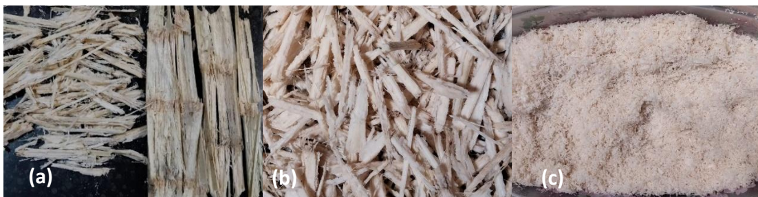
Figura 3 – Tratamento da cana-de-açúcar: (a) retirada do bagaço, (b) secagem e (c) Trituração. (Autoria própria, 2025).
