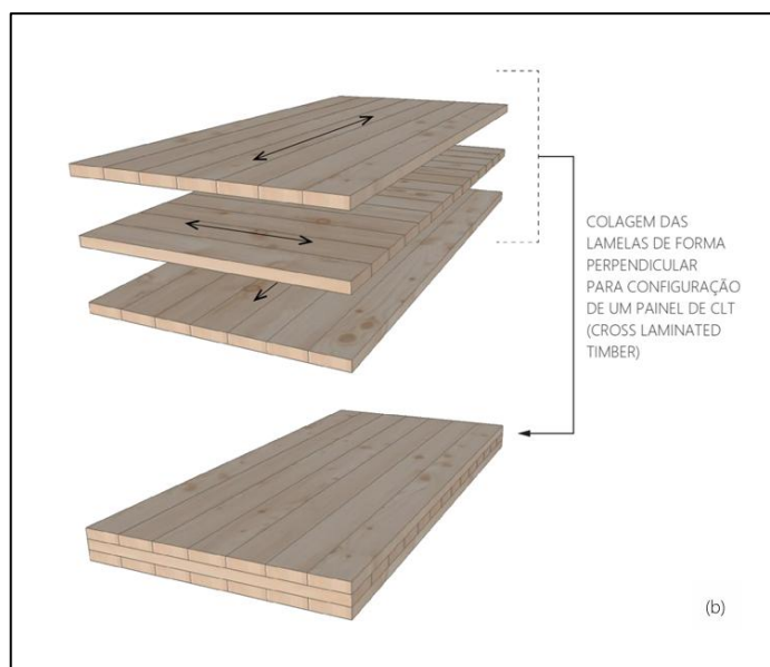
Figura 4 – Configuração construtiva de um painel de CLT
