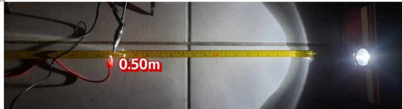
Figura 10: Medida de 0.50 m entre o fotoresistor e a lanterna.
