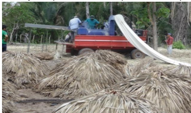
Figura 7: Batação da palha de carnaúba por meio de maquinário
