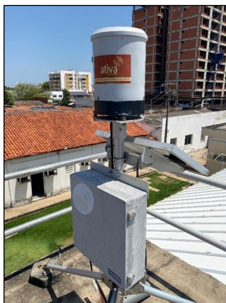
Figura 5 - Pluviômetro automático ligado à plataforma de coleta de dados da estação Ilhotas (Código 221100104A).
