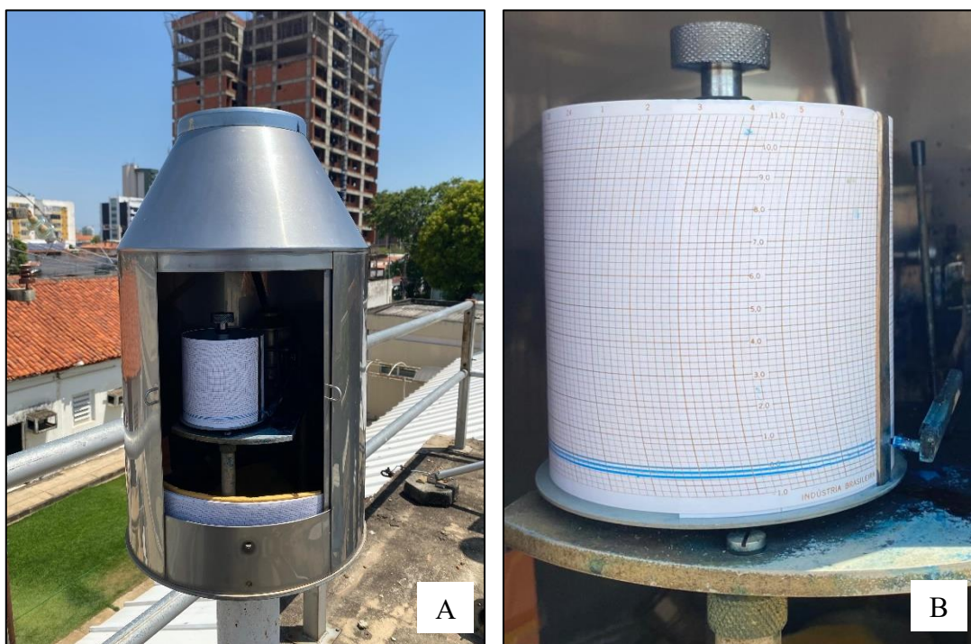
Figura 2 - Pluviógrafo da estação Teresina (código ANA - 00542012), operada pelo Serviço Geológico do Brasil - SGB/CPRM.
