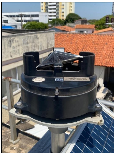
Figura 4 - Parte interna do pluviômetro automático da estação Ilhotas (Código 221100104A), operada pelo CEMADEN.
