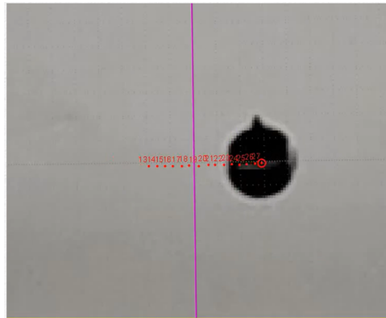
Figura 4: Detalhe da marcação manual no Tracker , tomando como referência o centro da bolinha.
