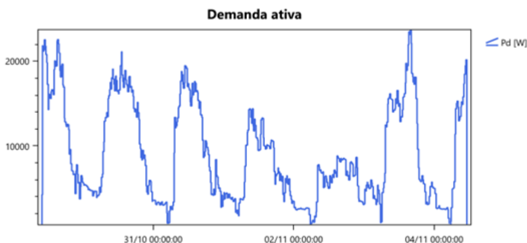
Figura 37 - Curva de demanda ativa de um dos circuitos da subestação B.
