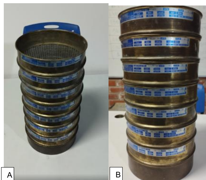
Figura 2 – Peneiras granulométricas utilizadas, abertura variando entre 4,75mm e 0,075 mm.
