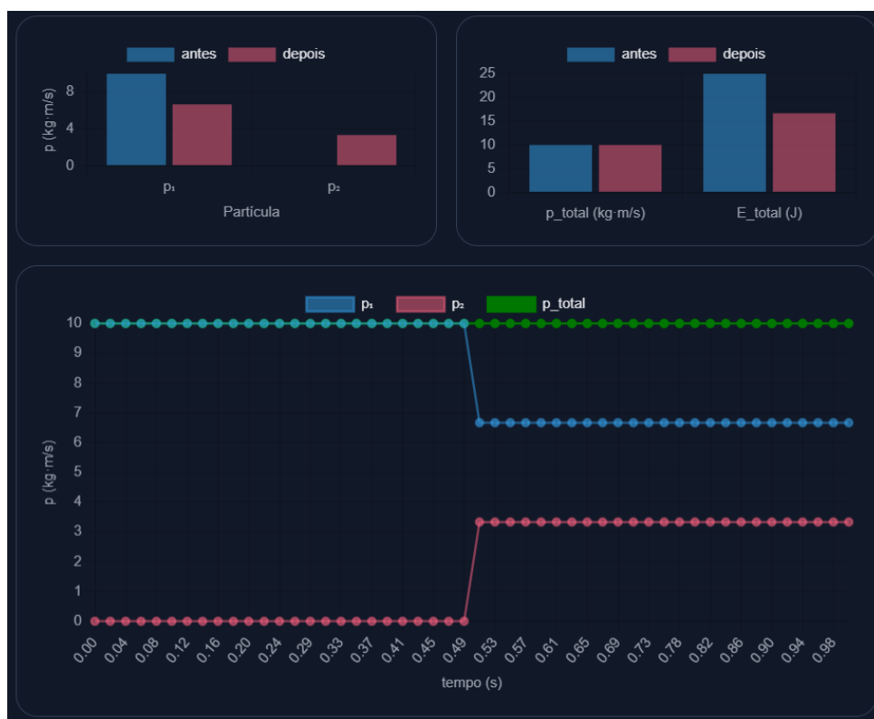
Figura 4.2: Gráficos gerados a partir da execução da simulação. O gráfico superior à esquerda mostra os momentos lineares antes e depois da colisão para os corpos 1 e 2. O gráfico superior à direita mostra o momento linear total e a energia total antes e depois da colisão. O gráfico inferior mostra a evolução com o tempo dos momentos lineares do corpo 1 e 2, e o momento linear total do sistema.
