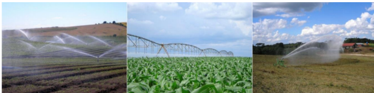
Figura 1 - Sistemas/Variações de irrigação por aspersão: sistema convencional (esquerda), sistema por pivô central (meio) e a carretel enrolador (direita).
