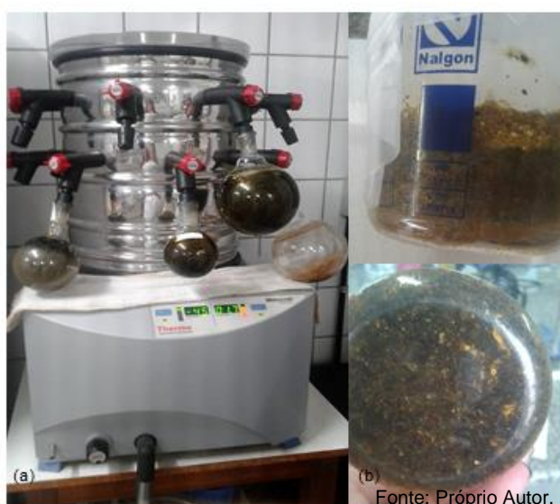
Figura 3.2: (a) Liofilizador ModulyoD Freeze Dryer, (b) Extrato etanólico após liofilização.
