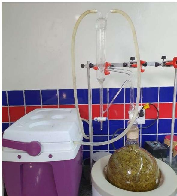
**Figura 3.1.** Fotografia do aparelho de *Clevenger* modificado por *Gottlieb*.
