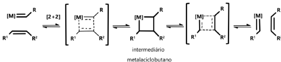
Figura 2.3. Mecanismo de reações de metátese com a formação do complexo metal- carbeno
