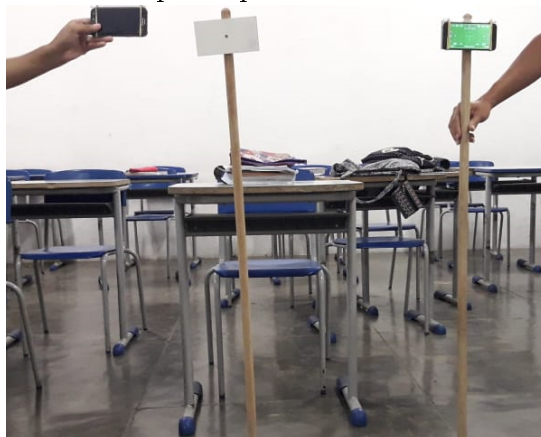
Figura 44: Teodolito auxiliado pelo aplicativo Theodolite construído pelos alunos
