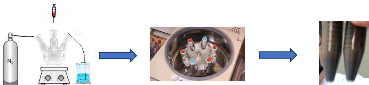
Figura 3.2 - Representação da obtenção do \text{TiO}_x\text{S}_y a partir da reação entre \text{TiCl}_4 e enxofre.
