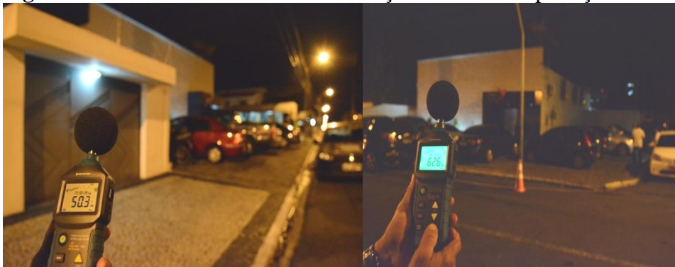
Figura 01: Uso do decibelímetro na medição de níveis de poluição sonora
